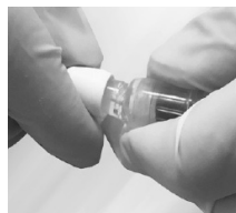
11. Nyomja a szeleptartót a fehér kupakba (egyenesen nyomja - ne csavarja meg)
